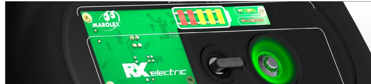
Mikroprocesorowe sterowanie zabezpiecza akumulator oraz wydłuża czas pracy pompy
